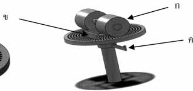
ภาพ 5 ลักษณะของทิศทางการหมุนของลูกกลิ้งที่ขบวัตถุ (ปุยอินทรีย์ผง) ผ่านช่องเล็ก ๆ บนงานอัลตราโซนิก ก) ลูกกลิ้ง 2 ลูกหมุนตามเข็มนาฬิกา ข) ใบกวาดเกลี่ยวัตถุให้สม่ำเสมอ ค) ใบตัดเม็ดปุย
