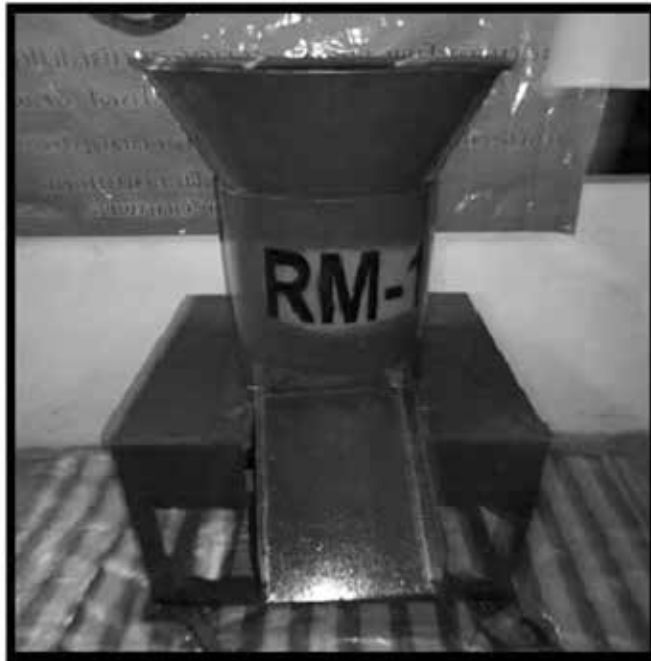
ภาพ 6 เครื่องอัดเม็ดปุ๋ยอินทรีย์ชนิดลูกกลิ้งแนวตั้งที่สร้างขึ้นตามแบบที่กำหนด (ที่แตกต่างจากเครื่องอัดเม็ดในกรมพัฒนาที่ดิน 2550 เป็นเครื่องที่ใหญ่ใช้น้ำมันเบนซินและการทำงานเสียงดังเกิดมลภาวะเป็นพิษ) จึงทำให้เกิดเป็น
